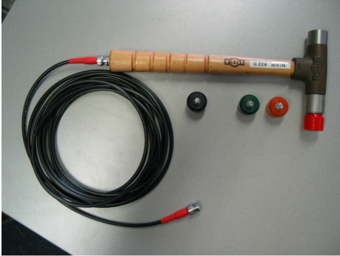
Abb. 2.15: Impulshammer zur Identifikation mechanischer Systeme [12]
