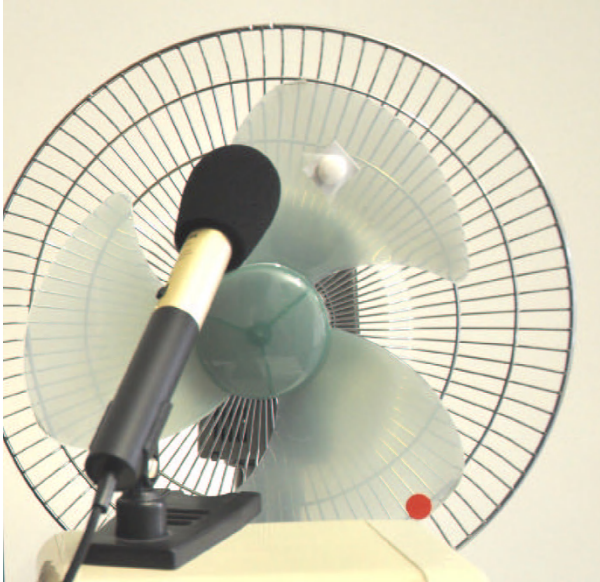
Abb. 5.50: Versuchsaufbau des Messsystems zur Geräuschanalyse eines handelsüblichen Tischventilators
