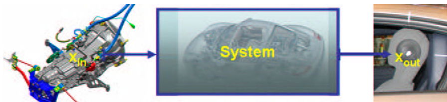
Abb. 1.5: Übertragungsweg von Getriebegeräuschen (hier Luftschall) als System
