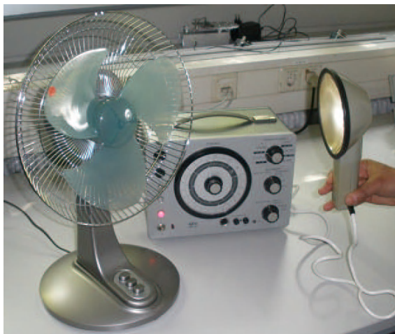
Abb. 3.10: Messung der Rotationsgeschwindigkeit eines Ventilators mit einem Stroboskop
