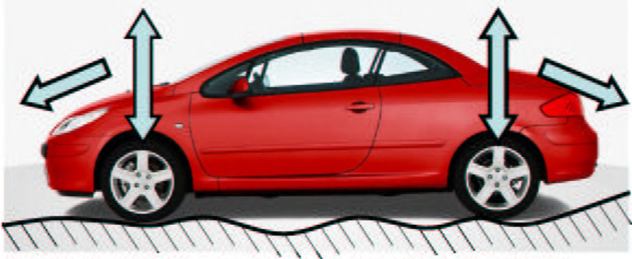
Abb. 1.1: Vertikaldynamik eines Fahrzeugs aufgrund der Fahrbahnanregung
